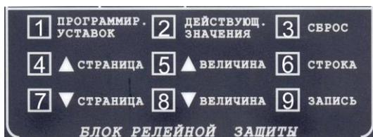
На обратной стороне реле IPR-A имеется кнопка **ПРОГР**, которой можно изменить настройки в меню ПРОГРАММИР. УСТАВОК или ДЕЙСТВУЮЩ. ЗНАЧЕНИЯ (диапазон: ДА/НЕТ) без ввода кода доступа.
